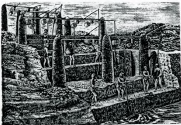
Рис.2. Система шадуфов древних египтян.
